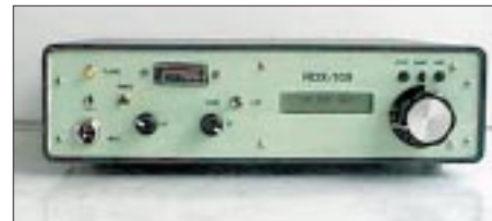
Der 9-Band-CW/SSB-Transceiver RTX 109 von Sheldon Hands aus England
