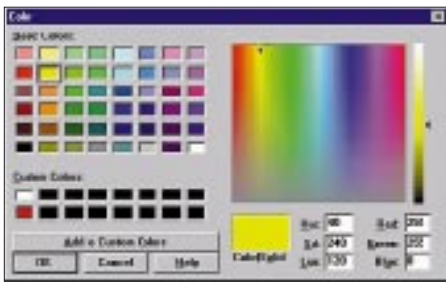
Bild 4: Wie hier bei der Farbauswahl innerhalb des Programms „PaintShop Pro“ setzt sich die ausgewählte Farbe aus Anteilen von Rot, Grün und Blau zusammen.
