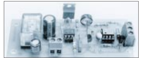
Bild 5: Ansicht der betriebsfertig bestückten Platine des elektronischen Postmelders mit Hausklingel
