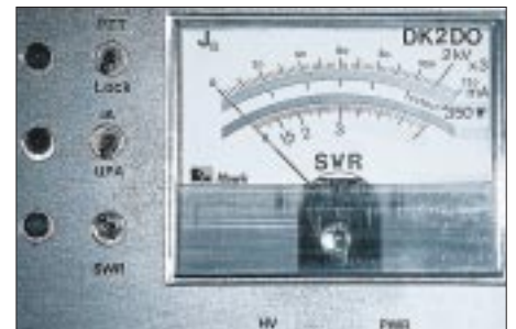
Bild 3: An der Gerätefrontplatte erfolgt die Auswahl zwischen Vor- und Rücklauf mit Kippaltern.
