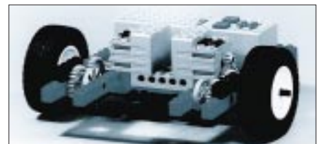
Bild 2: Für die Ausführung beliebiger Bewegungen in der Fläche erfolgt die Steuerung der Räder mit getrennten Motoren über ein Differentialgetriebe.
