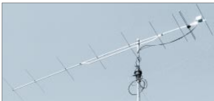
Fertig aufgebaute Antenne im Test; der vom Autor hinzugefügte Vorverstärker befindet sich in Dipolnähe an einem Ort, wo nach DK7ZB der Einfluß auf das Strahlungsdiagramm vernachlässigbar ist. Fotos: DL2RD
