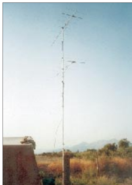
Der Standort in JM79 mit 2 x 9-El.-F9FT am Portabelmast
