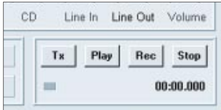
Bild 4: Mit Hilfe der Tasten Tx, Play, Rec und Stop können Sie via Headset eigene Töne, Geräusche oder gesprochene Worte aufnehmen, wiedergeben und senden.
