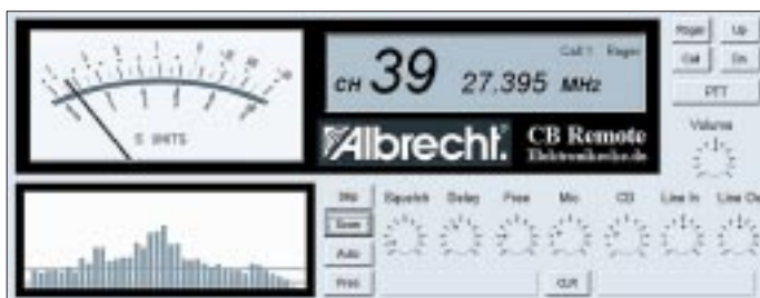
Bild 1: Mit der CBC100-Software kann CB-Funk direkt vom PC aus erfolgen.
