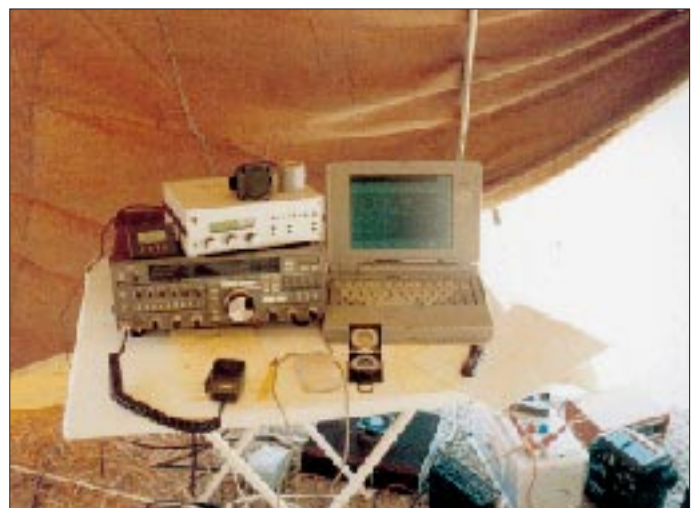
Bewährte Ausrüstung auch in Süditalien: FT736R, JUDP3, Notebook, 300-W-12-V-PA aus dem Akku gespeist. Fotos: DH7FB
